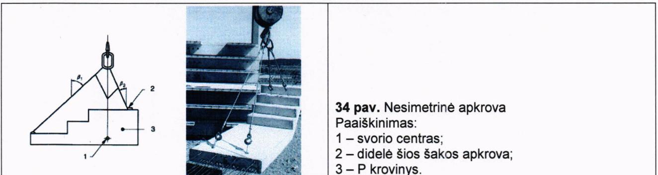
**34 pav. Nesimetetrinė apkrova**
