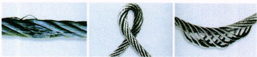
**40 pav.** Stropo lyno įlinkiai, suplonėjimai, išsipūtimai ar šerdies iškyšos ir kiti defektai deformuoojantys lyno konstrukciją
