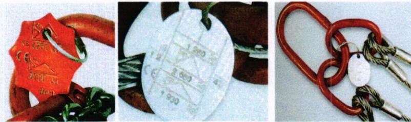
**8 pav. Stropų žyminiu plokštelių pavyzdžiai**
